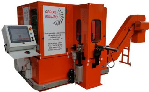
Machine de roulage / filetage
